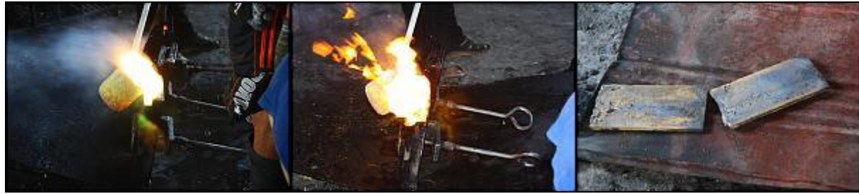
เนื้อโลหะผสมที่หลอมแล้วนำมาเทใส่แบบสี่เหลี่ยมให้เป็นแผ่นก่อนนำมารีดเพื่อป้อนเหรียญครับ
